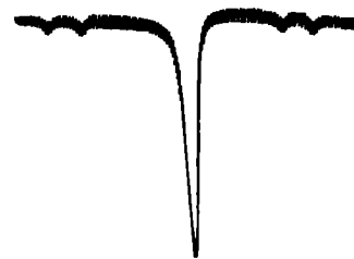
Рис. 3. Линия поглощения аммиака «3,3» на экране катодного осциллографа радиоспектрометра
